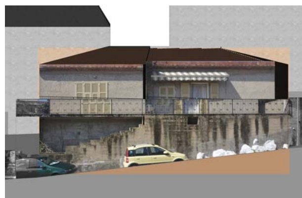
Profilo stato attuale (fotoraddrizzamento)
