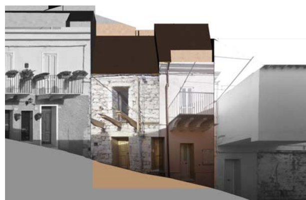
Profilo stato attuale (fotoraddrizzamento)
