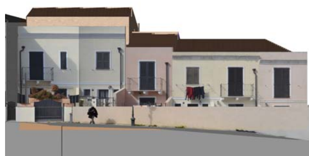
Profilo stato attuale (fotoraddrizzamento)
