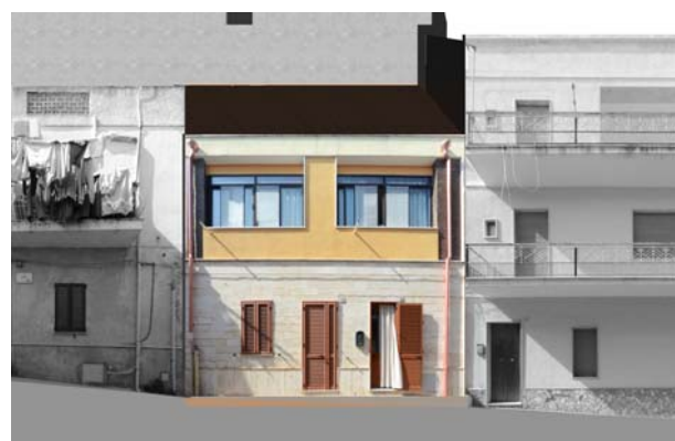
Profilo stato attuale (fotoraddrizzamento)
