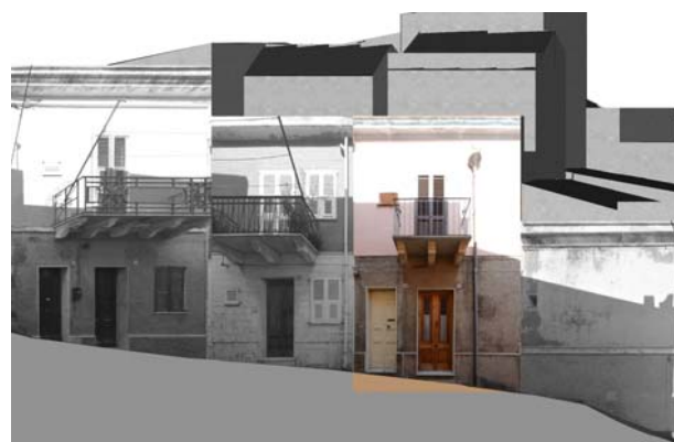
Profilo stato attuale (fotoraddrizzamento)
