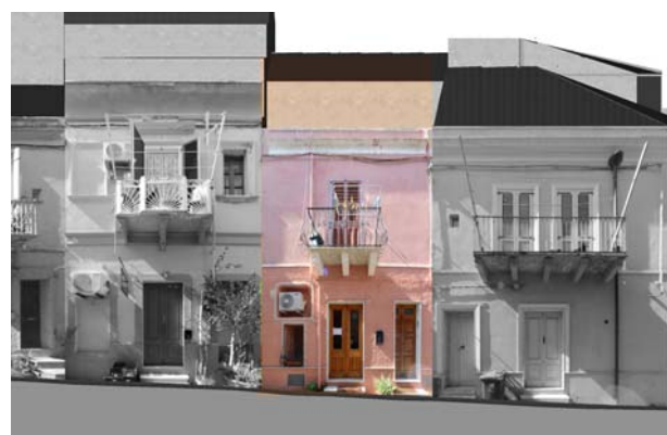
Profilo stato attuale (fotoraddrizzamento)
