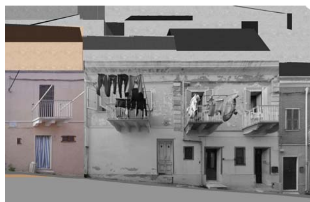
Profilo stato attuale (fotoraddrizzamento)
