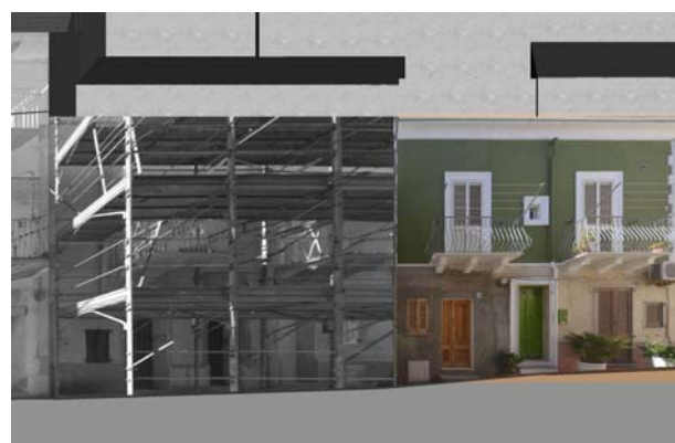
Profilo stato attuale (fotoraddrizzamento)
