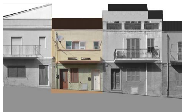
Profilo stato attuale (fotoraddrizzamento)
