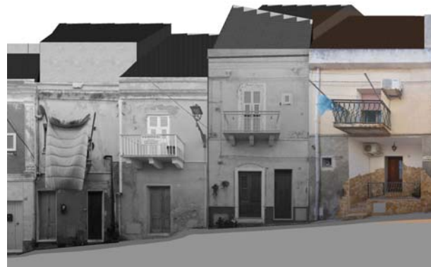
Profilo stato attuale (fotoraddrizzamento)
